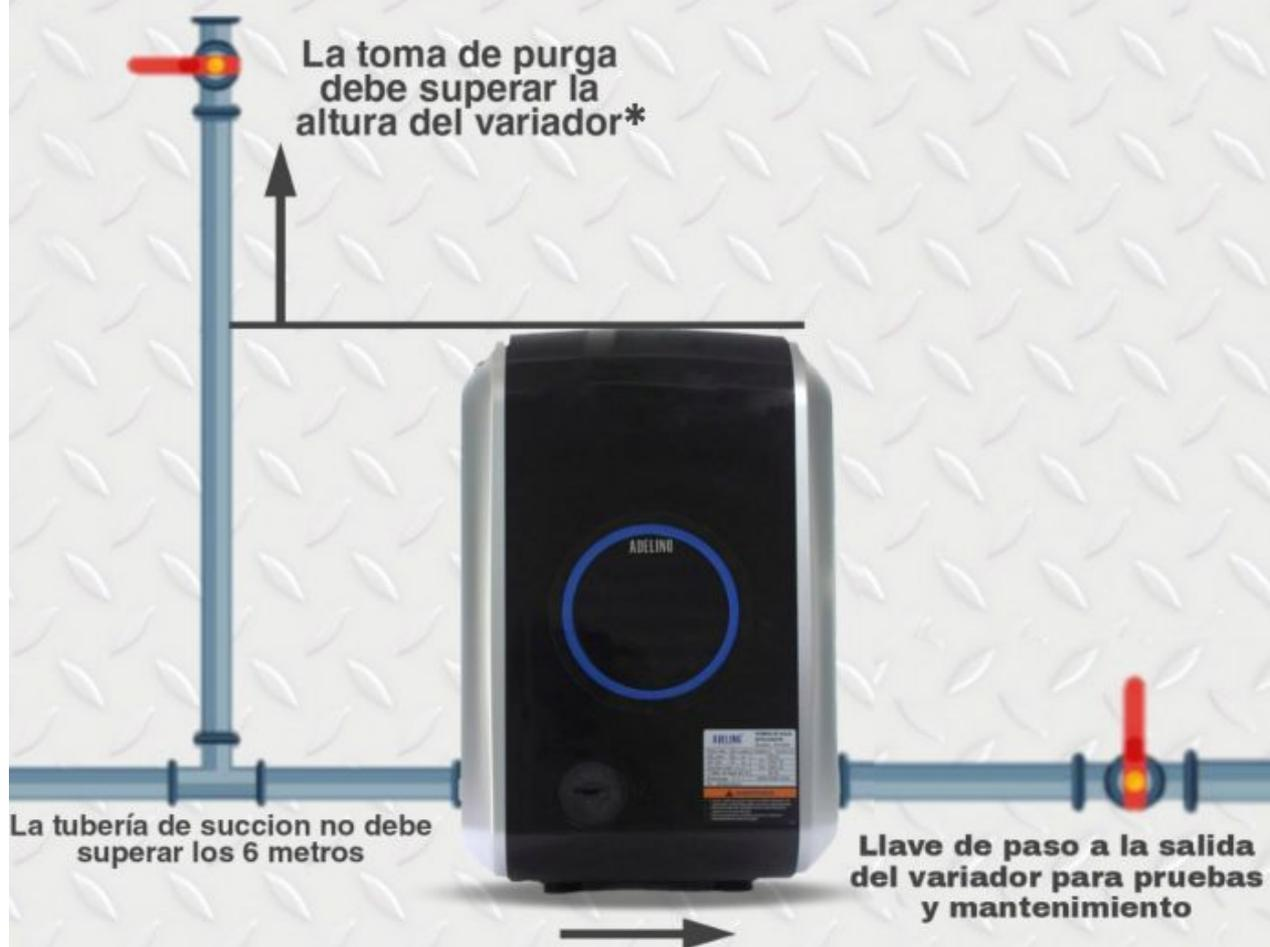
**1. NO colocar mas de 6 codos en la línea de succión del variador**
