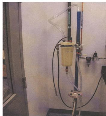
Prueba de impermeabilidad al agua. Standard EN 14891 A.7
